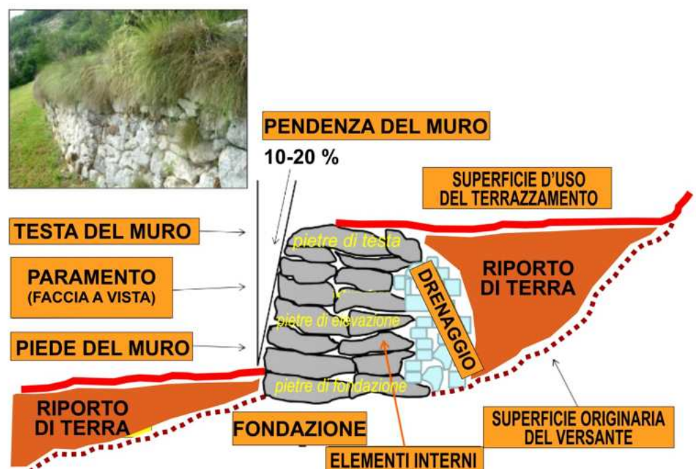
Fig. 2 Struttura schematica di un muro in pietre a secco con tutti gli elementi che lo compongono.
