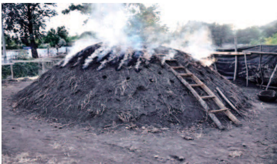
Fig. 3—Produzione del carbone di legna che avviene ancora secondo antichi metodi.
