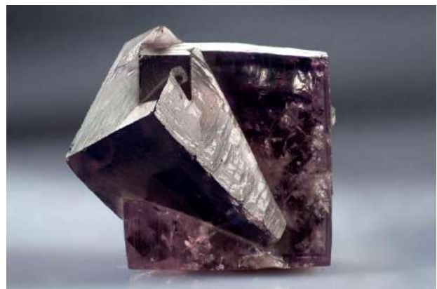
fig. 12 - Fluorite viola per presenza di difetti strutturali (a destra).
