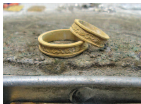
Coppia di fedi fuse con tecnica a cera in attesa della rifinitura
