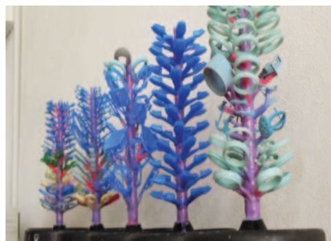
Alberi in cera pronti per l'inserimento nei cilindri
