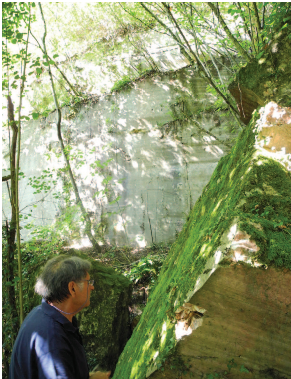
Cava della breccia di Castelvero. In primo piano grande blocco distaccato con la tecnica del taglio a filo, nello sfondo il fronte cava. (Foto F. Colombara)
