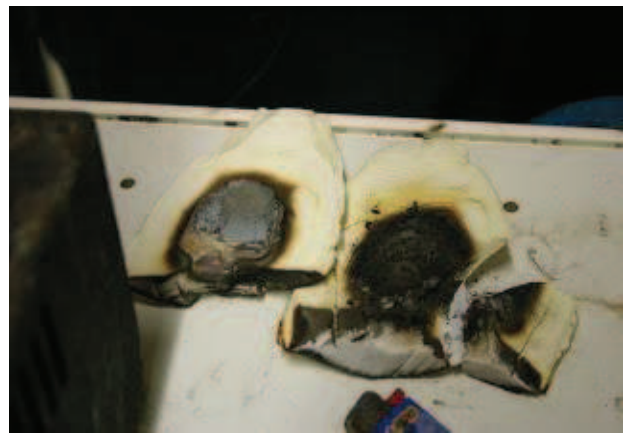
...e colato nella bocca dello stampo....che rimane praticamente carbonizzato e si sgretola all'apertura.....notare che sulla parte sinistra dell'osso è rimasta attaccata la lastrina di metallo fuso.
